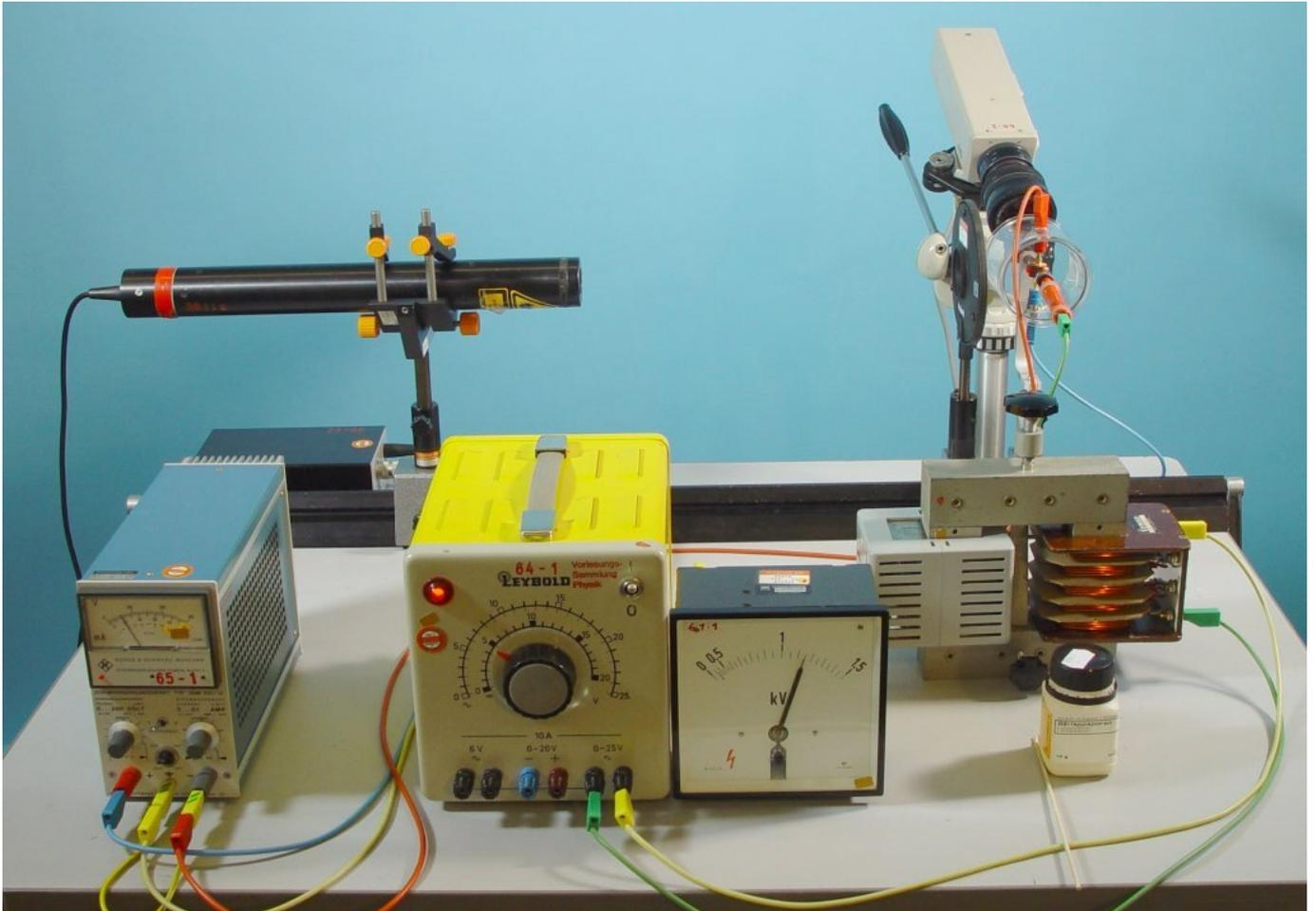
*Durchführung:* Offsetspannung auf 20-30V einstellen Spannung an der Ringelektrode auf etwa 4KV einstellen. Fläschchen mit Lycopodium kräftig schütteln, damit sich die Sporen auf laden, und mit Hilfe des PVC Stäbchens in die Mitte der Ringelektrode befördern.
