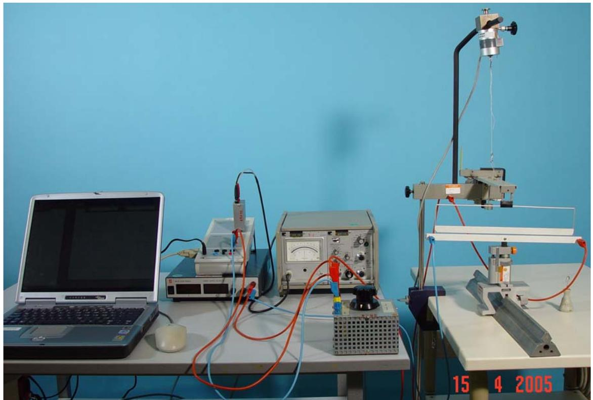
*Durchführung:* Darstellung  $F(I)$  wählen und Strom in 2-A-Schritten erhöhen und jeweils mit der F9-Taste manuell einen Messpunkt aufnehmen. Am Schluss Strom wieder auf Null!
