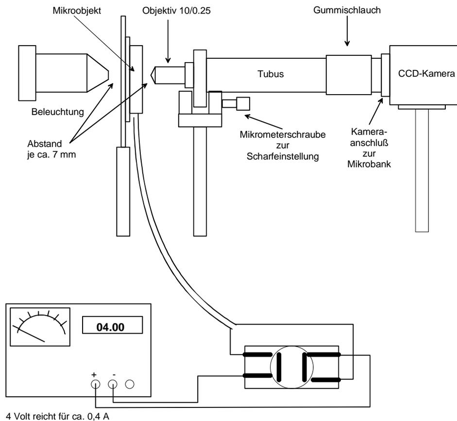
Die Spannungsversorgung erst anschließen, wenn die optische Abbildung justiert ist. Optische Justierung durch Feineinstellen des Abstands Objektiv-Objekt und Betrachten mit der Kamera.
