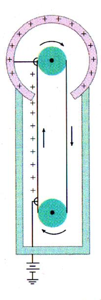
20.19 Schematischer Aufbau eines Van-de-Graaff-Generators. Das Band nimmt an seinem unteren Ende Ladungen auf und gibt sie am oberen Ende an einen Abnahmekamm ab, der mit der großen leitfähigen Kuppel verbunden ist.
