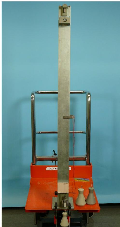
unten im Teil mit den Rädern. Gewichtsstück (1kg) zum Straffen des Drahts anhängen; eine Büroklammer als Zeiger im Bereich der Skala befestigen. Kamera einstellen.
