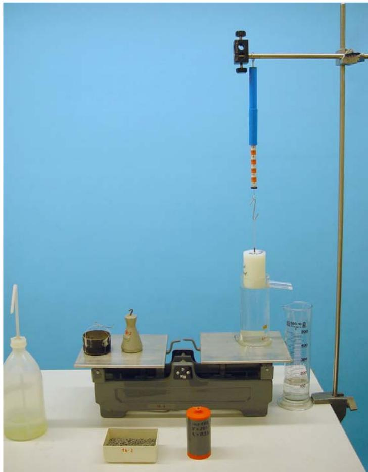
Aufbau: Gefäß mit Überlaufrohr auf die Tafelwaage stellen und mit demin. Wasser (mit etwas Spülmittel entspannt) bis zum Überlaufrohr füllen. Waage austarieren.
