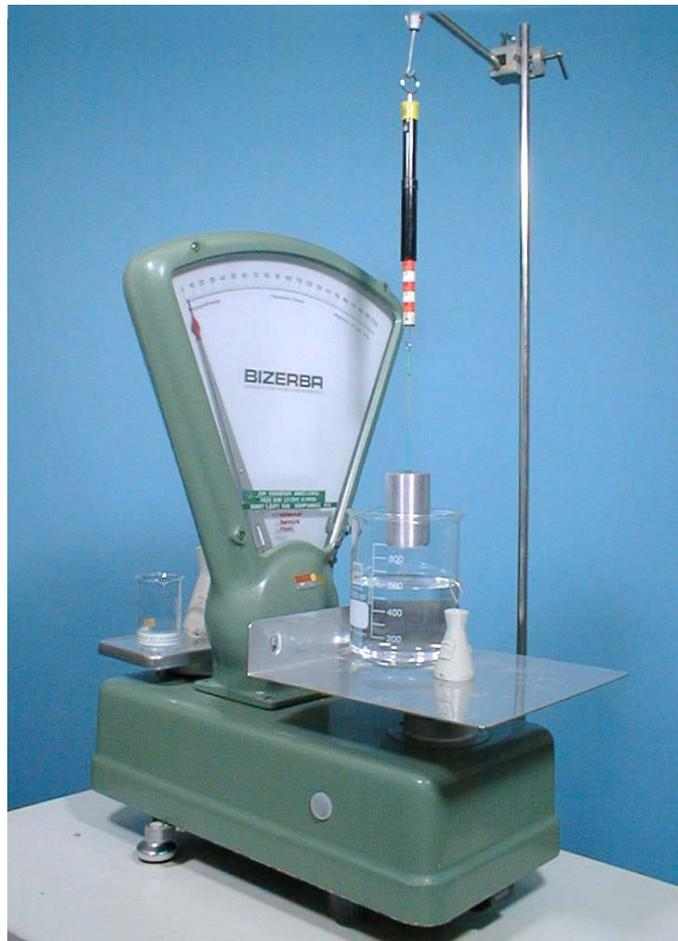
2. 800-ml-Becherglas und 200-g-Wägestück auf die Wägeplatte stellen. Becherglas mit Wasser füllen, bis die Waage „0“ anzeigt.
