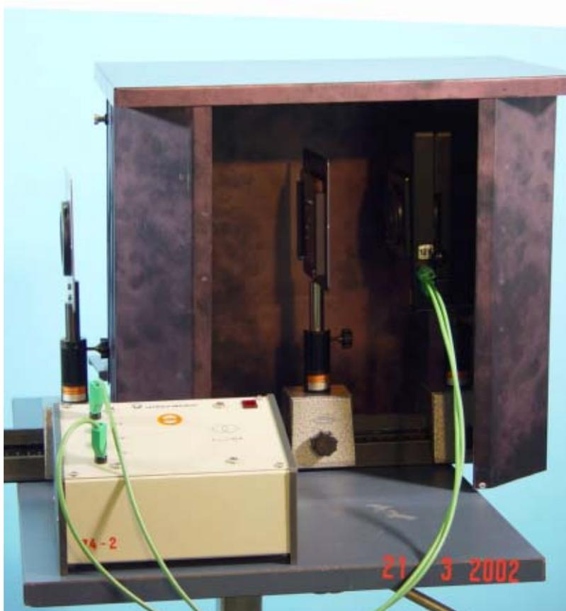
Aufbau: Beleuchtete F-Blende mit dem Objektiv und dann mit der Lochblende (in Abhängigkeit von der Lochgröße) abbilden. Abstand für das Objektiv einstellen, dann Lochblende in den gleichen Reiter stellen.
