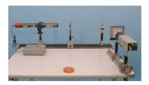
Auf dem anderen Tisch den Drehspiegel mit der Frequenzmessung montieren. Linse f=5 m und Planspiegel je auf ein Fotostativ (Dreibein) montieren.
