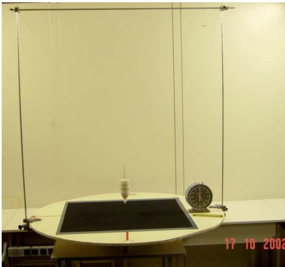
Schwingungsdauer senkrecht zur Bildebene:  $T_1 = 2\pi \sqrt{\frac{l_1 + l_2}{g}}$
