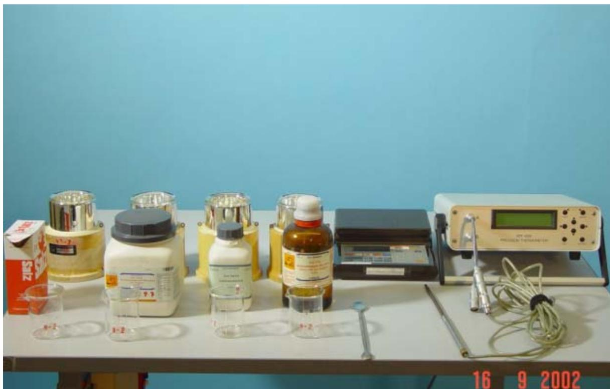
Durchführung: Messung der Temperaturänderung mit Pt-100 oder Thermometer. Mit Thermofühler umrühren.
