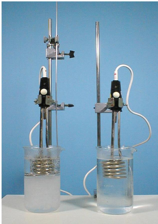
Aufbau: In jedes Becherglas Eiswasser einfüllen (mit deutlichem Eisanteil). Im linken Becherglas Tauchsieder ganz eintauchen (Wärmeleitung und Konvektion) und im rechten Becherglas das Eis mit dem Drahtgitter nach unten drücken und den Tauchsieder nur wenig eintauchen (nur Wärmeleitung). Beide Tauchsieder an die ausgeschaltete Steckdosenleiste des Tisches anschließen.
