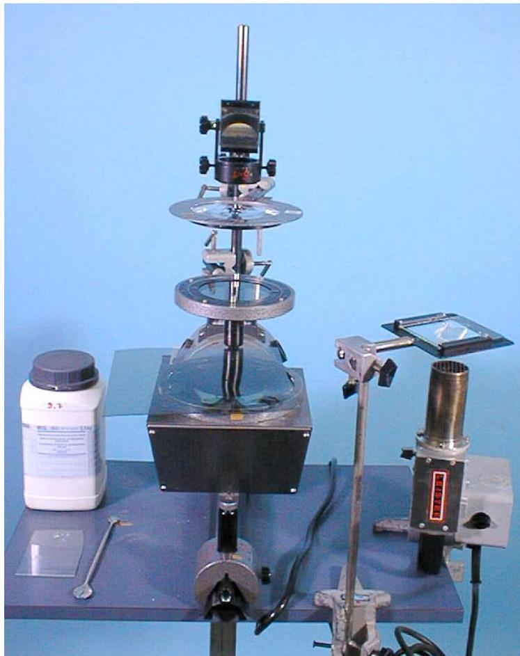
Durchführung: Heißluftgebläse schmelzen. Zweites Glas (Objektträger) drauf legen und zusammendrücken, zwischen gekreuzte Polarisatoren bringen und abkühlen lassen.
