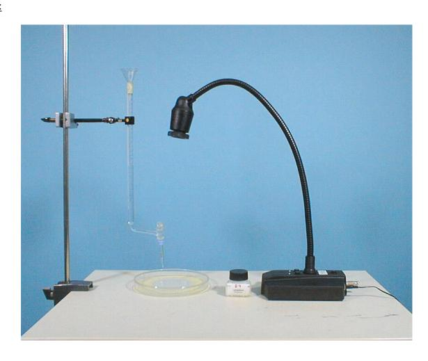
Messung des Volumens eines Tropfens der Lösung durch Titration:  $V_{\text{Tropfen}}$  Große Petrischale mit Demin. Wasser füllen, Bestäuben der Oberfläche mit Bärlappsamen.
